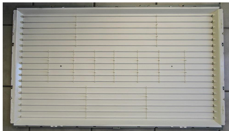
Рисунок 2.5 – 18 паралельних CCFL-ламп для підсвічування РК-телевізора
