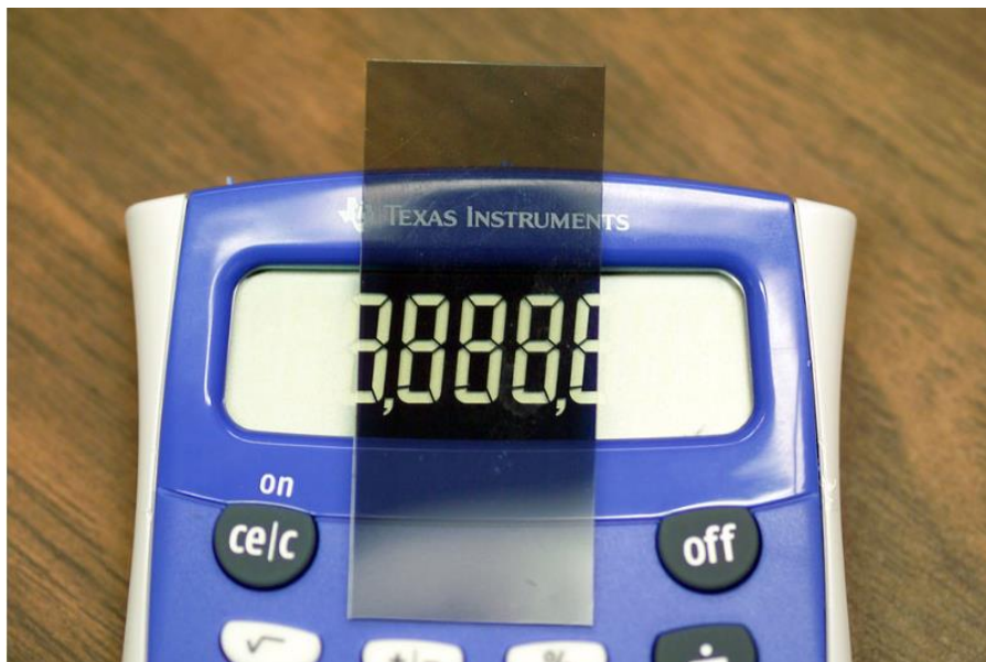
Рисунок 2.2 – РК-дисплей зі знятим та повернутим верхнім поляризатором
