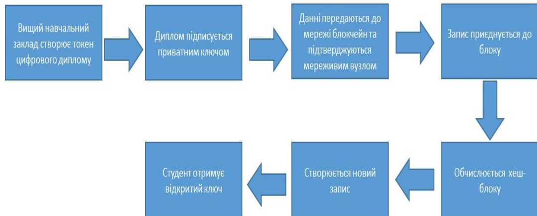
Рисунок 1.3 – Принцип роботи технології блокчейн
