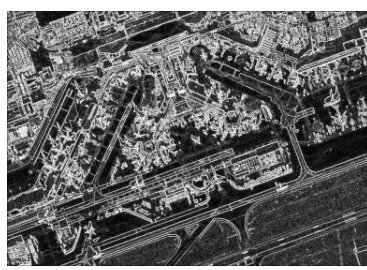
б) маска изображения после ДКП с квантованием q = 1
