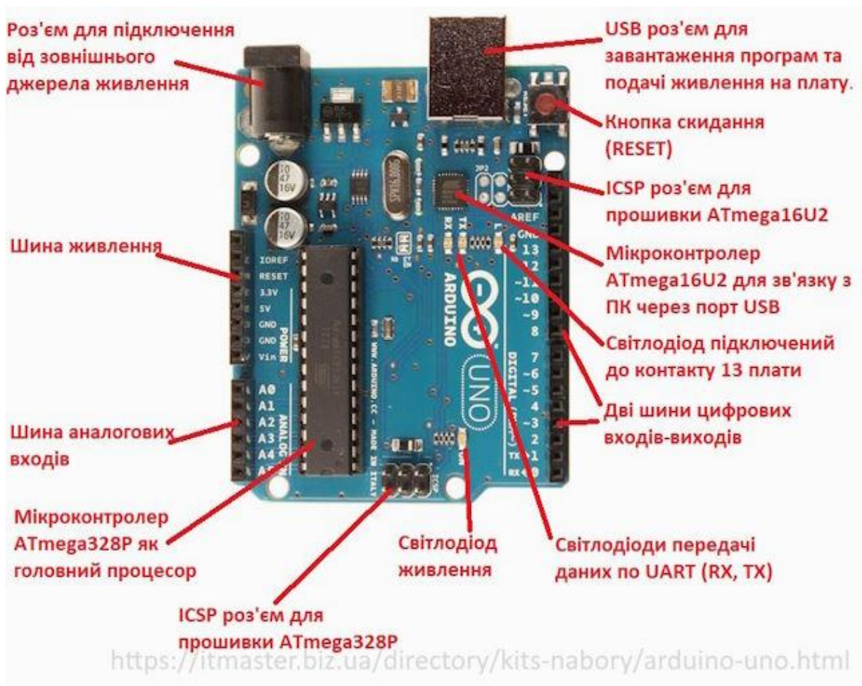
Рисунок 2.1 – Плата Arduino Uno [7]
