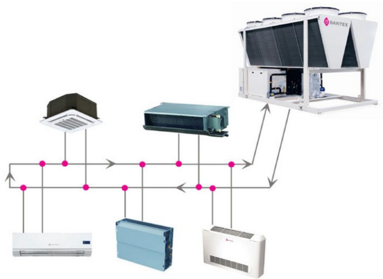
Рисунок 1.13 – Архітектура чилер-фанкойл системи кондиціонування
