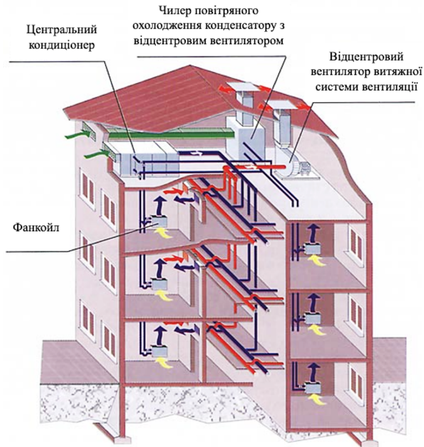
Рисунок 1.3 – Інженерно-технічне структура системи кондиціонування типового підприємства гостинності
