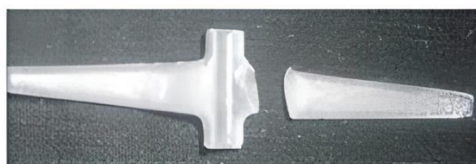
Рис. 2. Типова картина перелому протеза ПФС за «Swanson» в зоні з'єднання дистального стрижня та суглобового елемента
