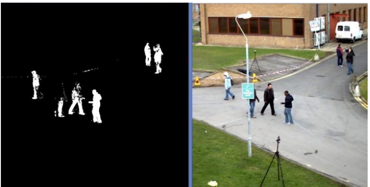
Рисунок 1.7 – Визначення об'єктів методом віднімання заднього фону
