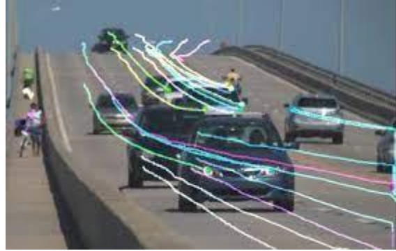
Рисунок 1.3 – Приклад визначення оптичного потоку методом Лукаса-Канаде
