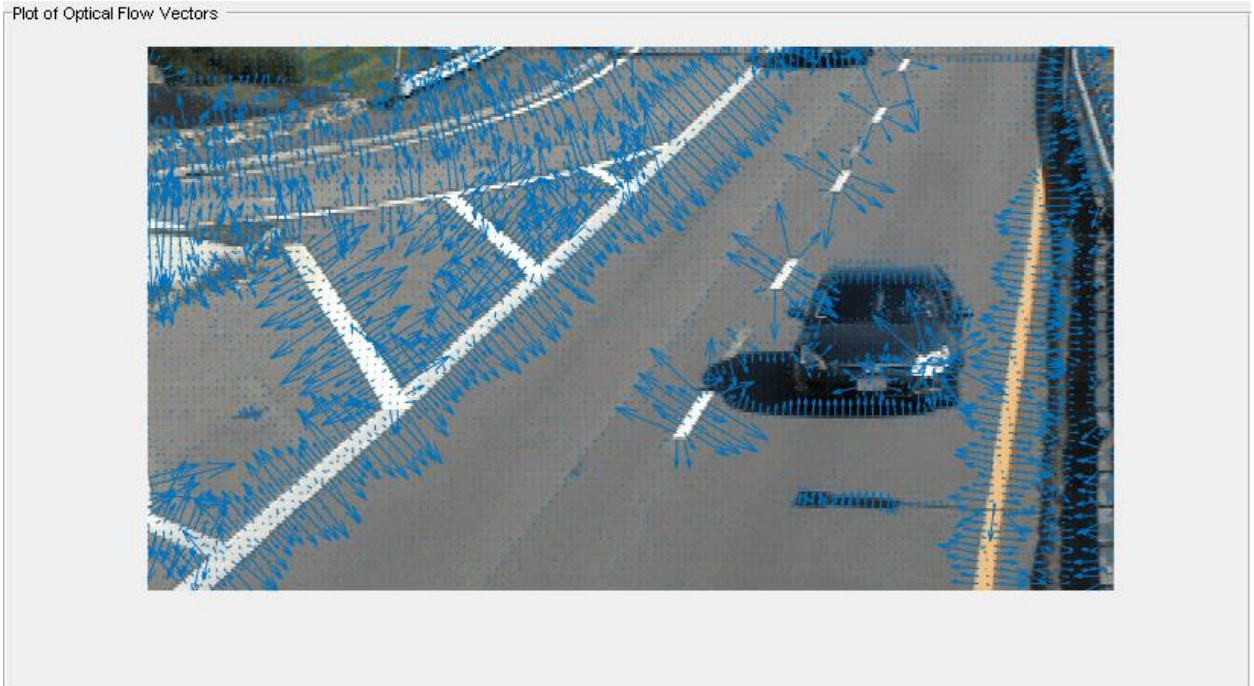
Рисунок 1.5 – Приклад визначення оптичного потоку методом Хорна-Шунка
