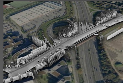
Рисунок 4 – Фрагмент просторової 3D моделі земної поверхні, отриманої у ході лазерного сканування з використанням БПЛА
