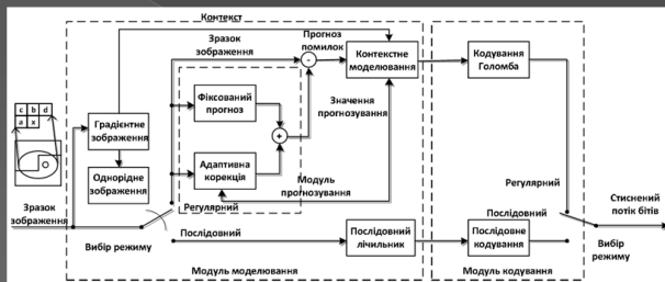
Рисунок 10 – Схема функціонування алгоритму JPEG-LS
