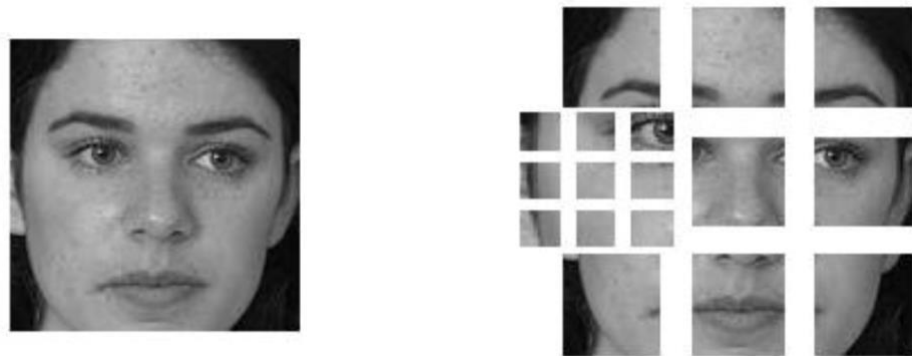
Рисунок 2.4 – Розділ зображення на підобласті, для обчислення окремої гістограми ЛБШ на різних ділянках
