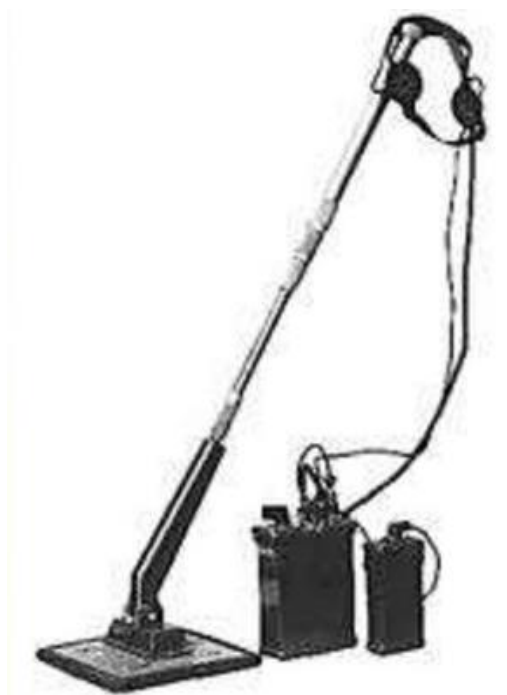
Рисунок 2.15 – Індукційний міношукач ІМП-2
