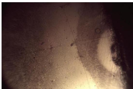
Рисунок 2 Зона лазерного воздействия, сталь У12, ×320
