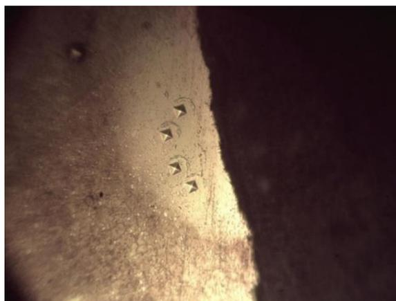
Рисунок 3 Зона лазерного воздействия, сталь Р6М5, ×320
