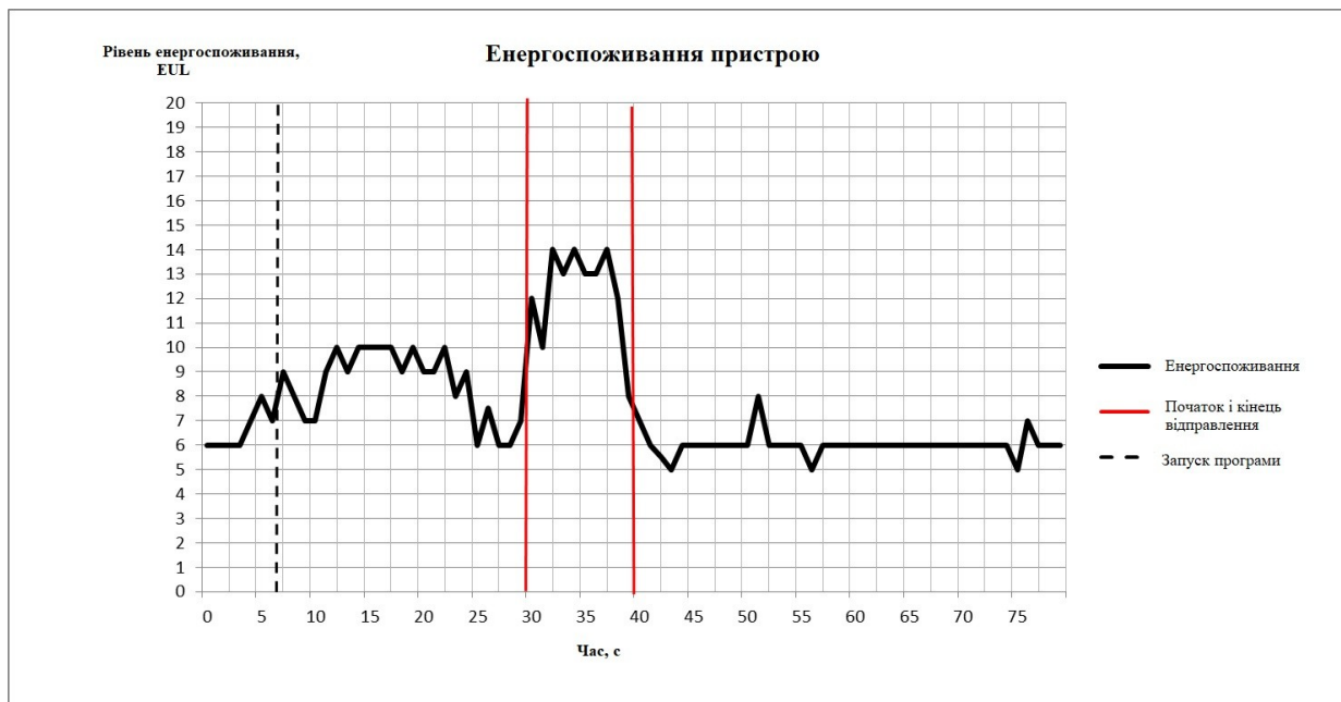
Рисунок 4.6 – Графік енергоспоживання пристрою з активним застосуванням DDMailSender (збільшено кількість потоків, що беруть участь у відправці)
