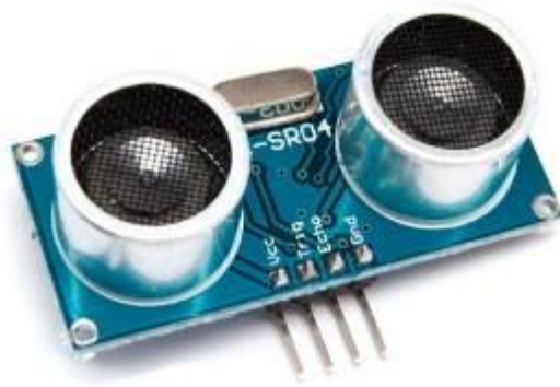
Рисунок 3.10 – Ультразвуковий сонар HC-SR04
