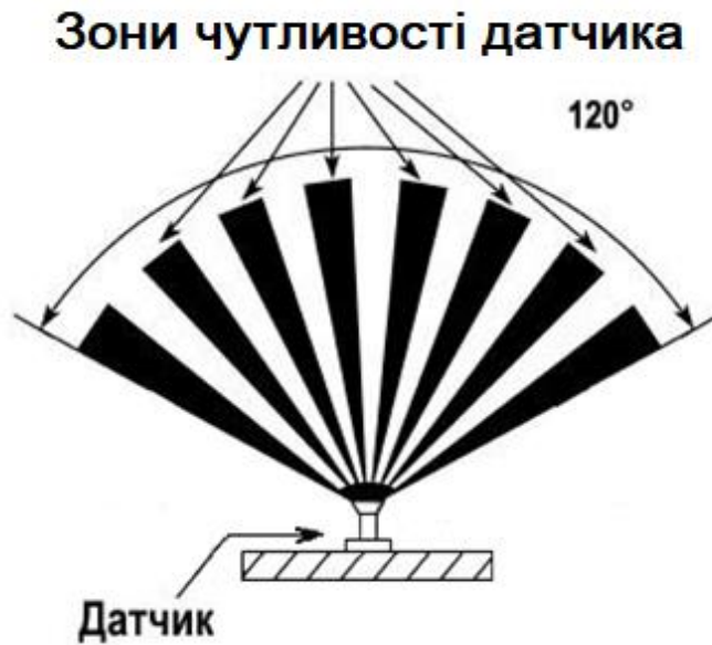
Рисунок 1.1– Горизонтальний сектор огляду ІЧ датчика
