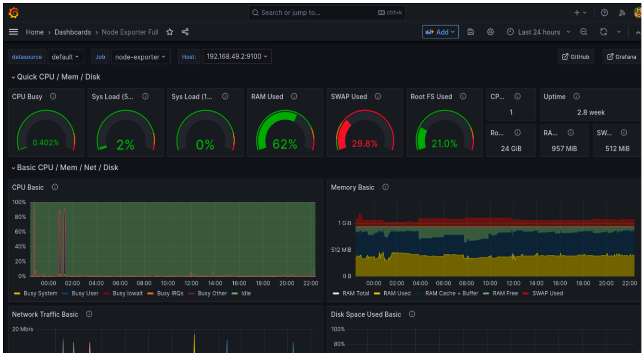
Рисунок 3.17 – Інформаційна панель моніторингу кластеру та системи
