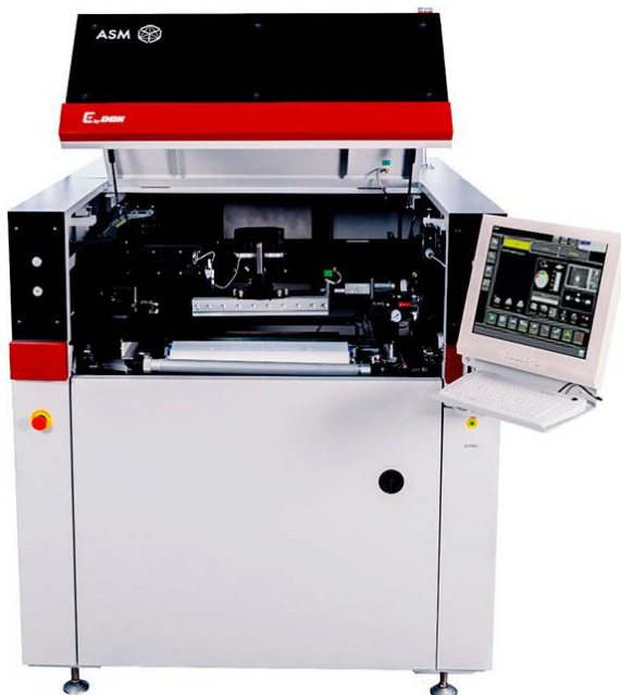
Рисунок 2.3 – Автомат трафаретного друку DEK 01 iX [15]
