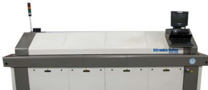
Рисунок 2.7 – Конвекційна лінійна піч XPM 1030 [15]
