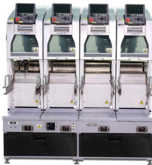
Рисунок 2.6 – Автомат установки компонентів FUJI 4Mi3S [15]
