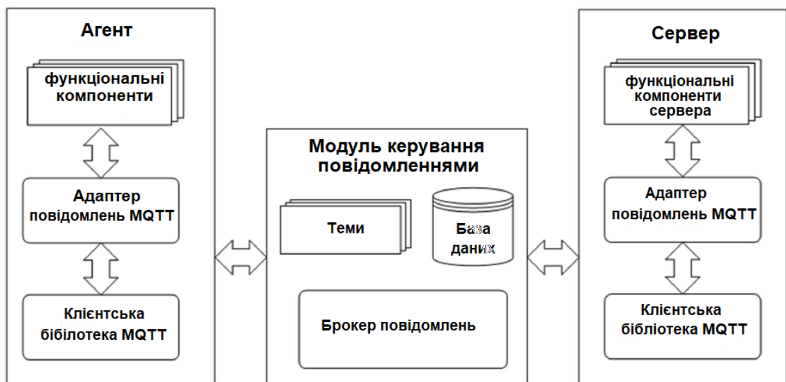
Рисунок 3.12 – Архітектурна схема модуля обміну повідомленнями з використанням MQTT
