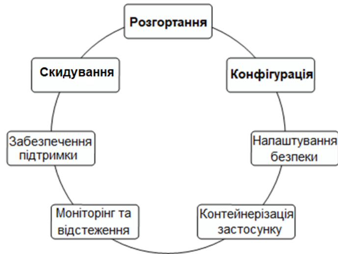
Рисунок 1.1 – Життєвий цикл мобільних пристроїв у корпоративній мережі
