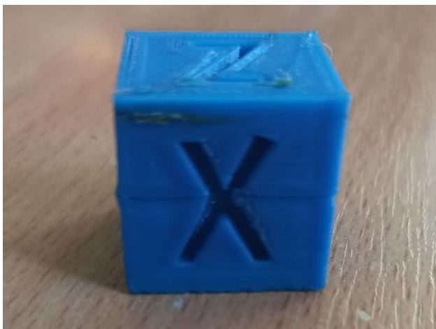
Рисунок 3.21 – Калібрувальний куб з дефектом зміщення
