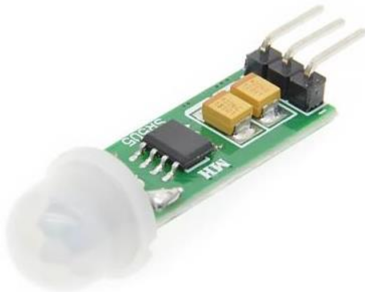
Рисунок 3.6 – ІЧ-датчик руху HC-SR505
