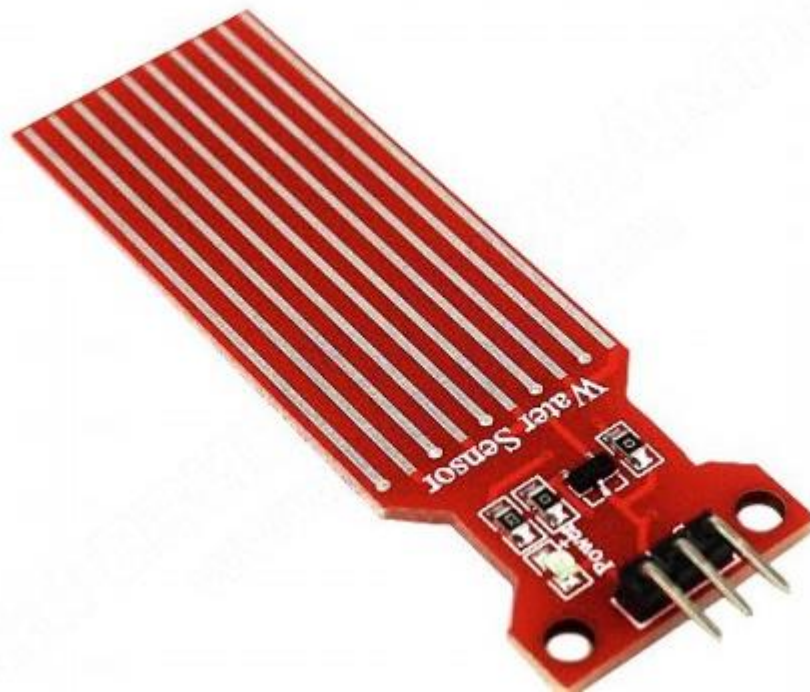
Рисунок 3.8 – Датчик провідності T1592
