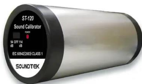
Рисунок 4.2 - Калібратор шуму TENMARS ST-120 (IEC 60942 : 2003 ): Клас точності – 1, Діапазон звукового тиску – 94 ...114 дБ, Точність - 94 ±0,3 дБ, 114 ±0,5 дБ.
