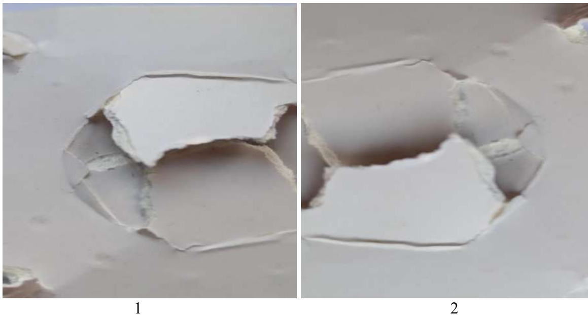
Рисунок 11 – Зразки лакованого картону після досліджень на продавлювання: 1 – SinarVanda GC1 – 245 г/м 2 ; 2 – SinarVanda GC1 – 280 г/м 2
