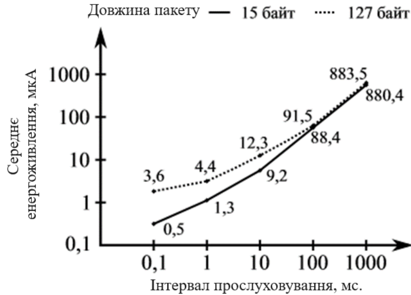
Рисунок 3.8 – Залежність середнього споживання енергії від тривалості інтервалу прослуховування
