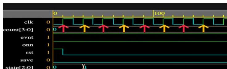
Рисунок 3.15 – Часова діаграма роботи автомата, коли зовнішня подія не відбувається
