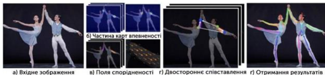
Рисунок 1.14 – Алгоритм роботи OpenPose
