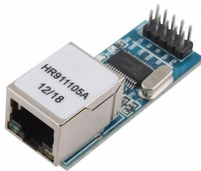
Рисунок 2.3 – Модуль розширення на мікросхемі ENC28J60 [11]
