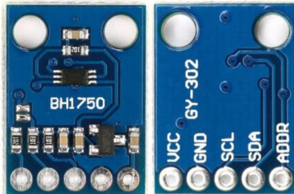
Рисунок 2.5 – Датчик вимірювання освітленості GY-302 [13]
