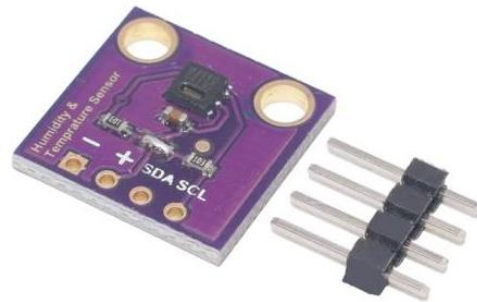
Рисунок 2.4 – Модуль датчика на мікросхемі SHT20 [12]
