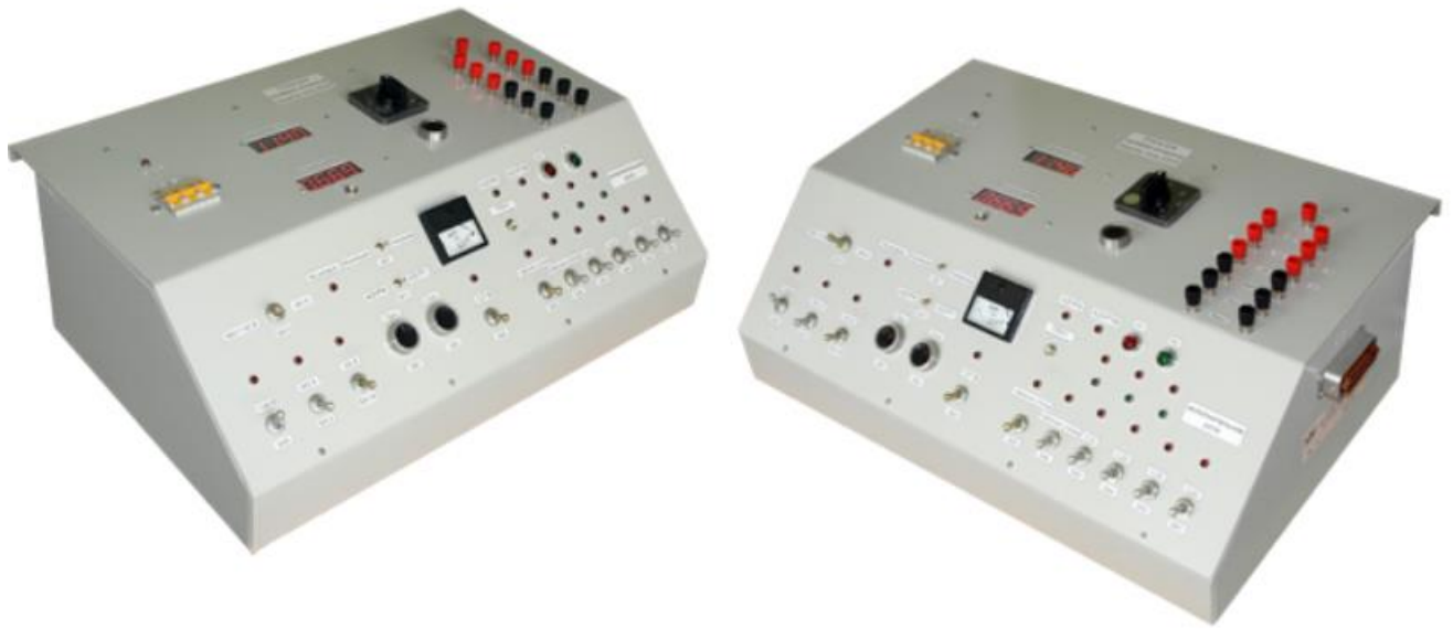
Рисунок 3.3 – Стенд для перевірки та налаштування апаратів захисту типу АЗУР
