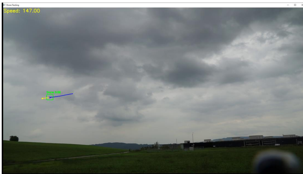
Рисунок 3.14 – Візуалізація результатів відстеження дрона з відображенням вектора швидкості та траєкторії руху
