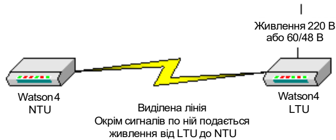
Рисунок 3.7 - Схема живлення модулів LTU/NTU
