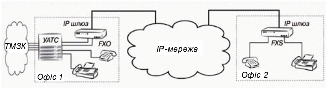
Рисунок 2.1 – Принцип дії IP-телефонії
