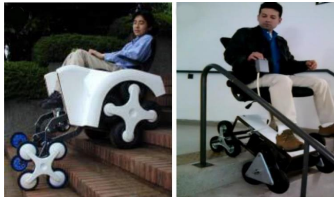
Рисунок 5 – Механізм підйому по сходах на базі чотирьох або більшої кількості груп коліс
