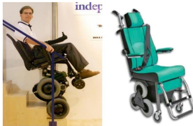
Рисунок 4 – Механізм підйому по сходах на базі двох груп коліс
