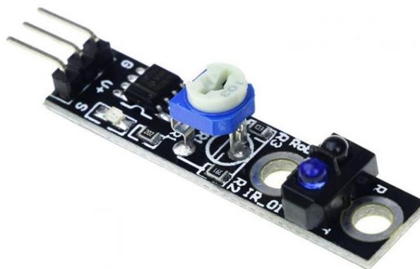
Рисунок 4.2 – Кінцевий датчик KY-033 на TCRT5000
