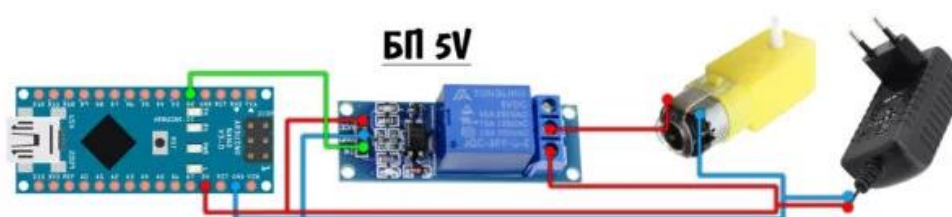
Рисунок 3.13 – Схема підключення двигуна до модуля управління
