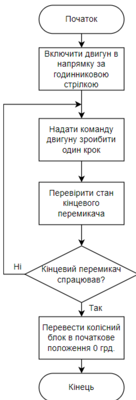
Рисунок 4.1 – Алгоритм роботи модуля сортування в режимі калібрування
