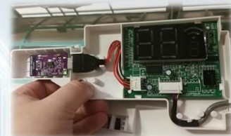
NodeMCU підключений по UART до кондиціонера
