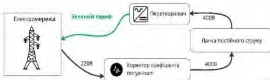
Рис. 3. Схема з'єднання мережі та ланки постійного струму
