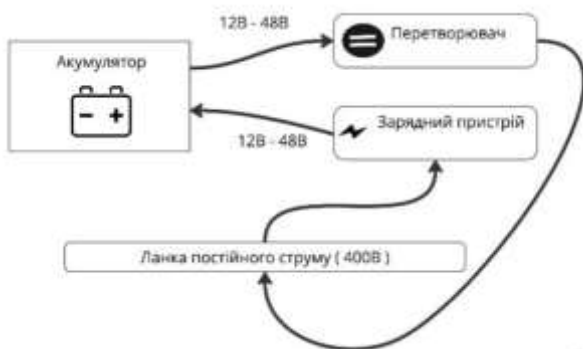
Рис. 2. Схема з'єднання акумулятора й ланки постійного струму
