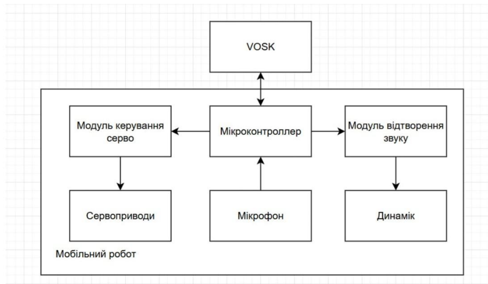
Рисунок 1 – Архітектура системи мобільного робота
