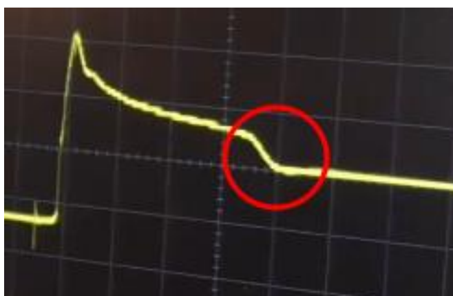
Рисунок 3.32 – Зміна сигналу якщо міна потрапляє в поле дії котушки
