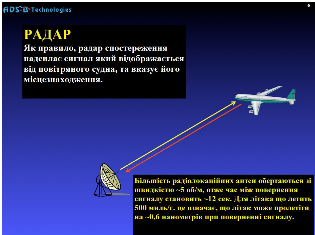
Рисунок 2.2 – Принцип роботи звичайного радіолокатора
