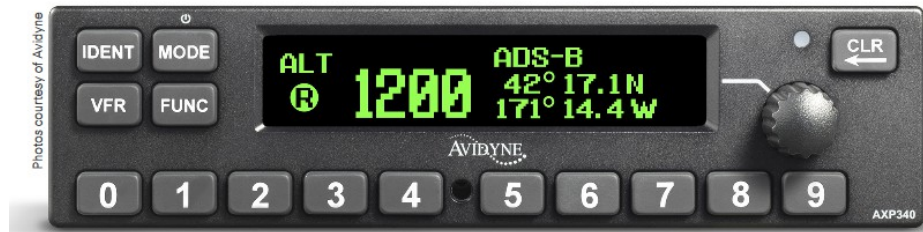
Рисунок 1.2 – Консоль обладнання Avidyne AXP340 Mode S
