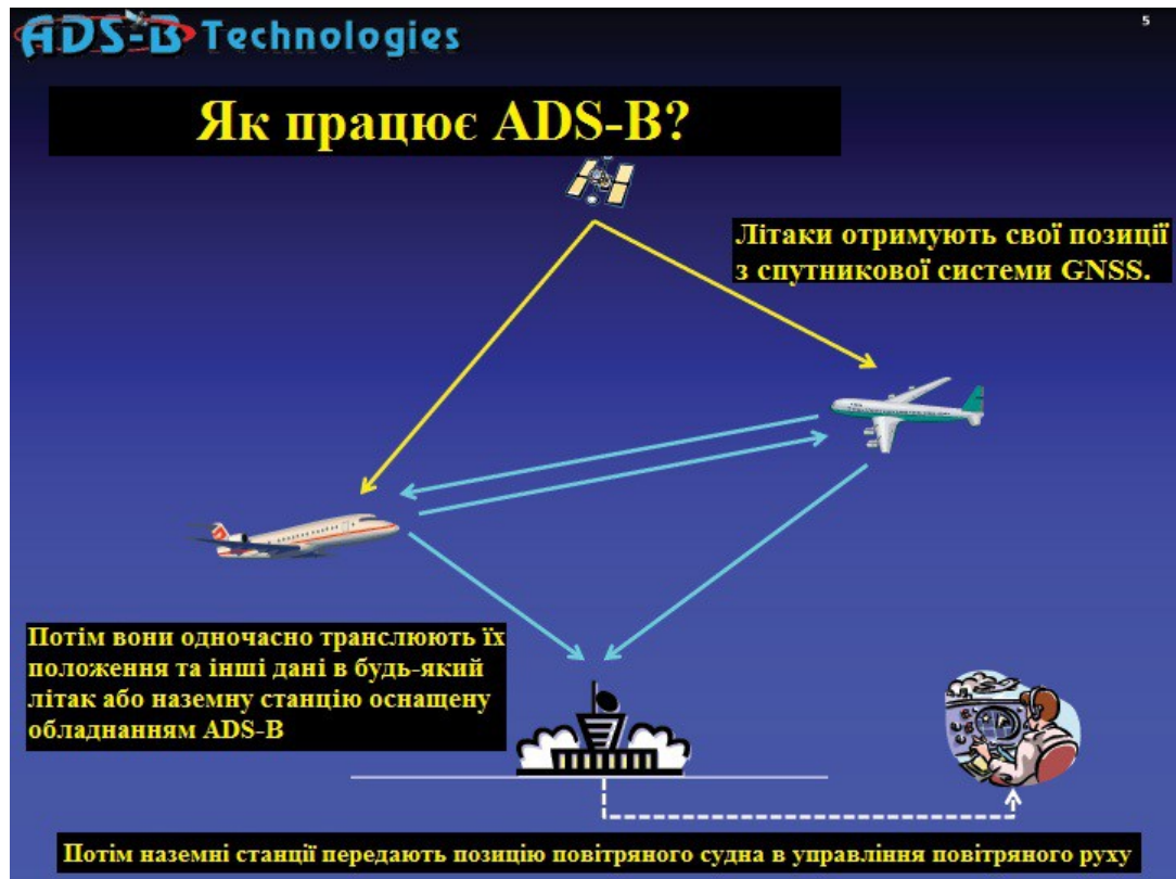
Рисунок 2.1 – Принцип роботи ADS-B
