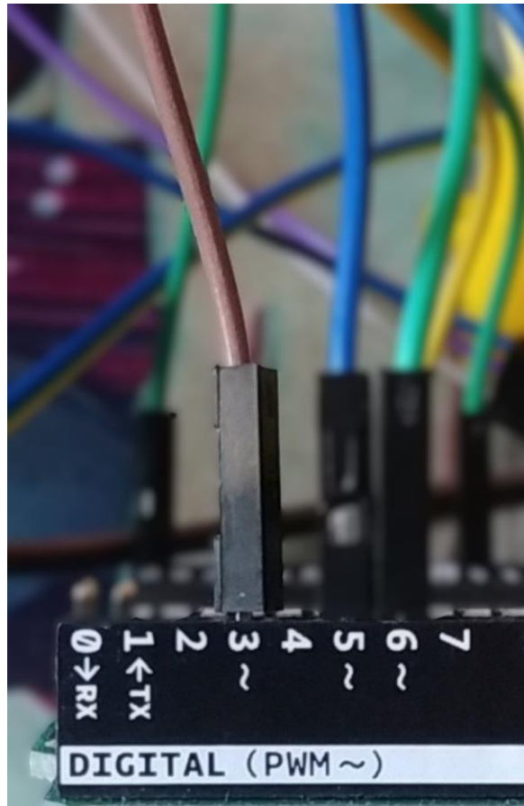
Рисунок 4.19 – Підключення керування лампою до мікроконтролера
