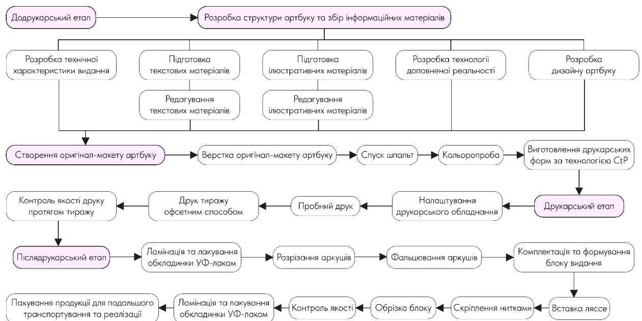
Рисунок 4.1 – Схема технологічного процесу виготовлення видання
