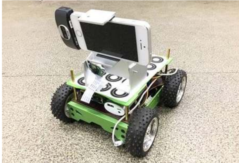
Рисунок 2.2 – Приклад інтелектуального мобільного «s-bots», керованого нейронною мережею
