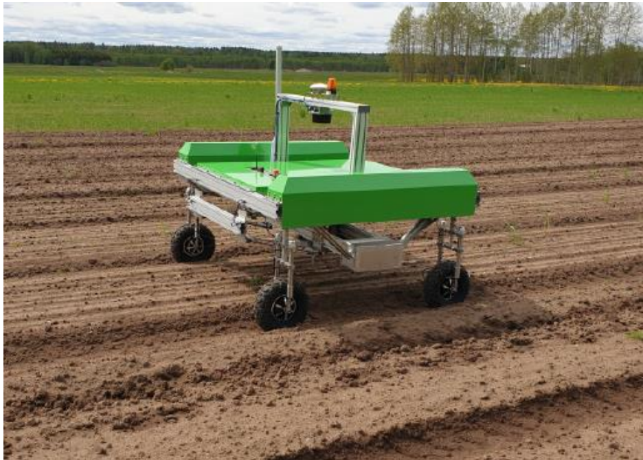
Рисунок 1.1 – Автономний робот для прополки.
