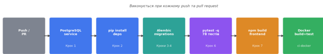
Рисунок 3.1 – Схема CI/CD пайплайну платформи
