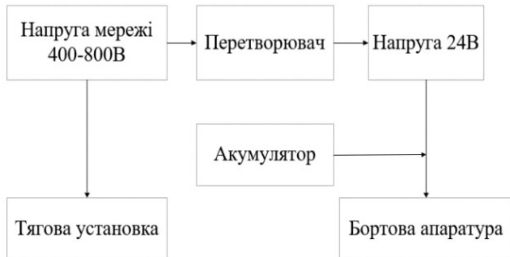
Рисунок 1.2 – Система електроживлення звичайного тролейбуса
