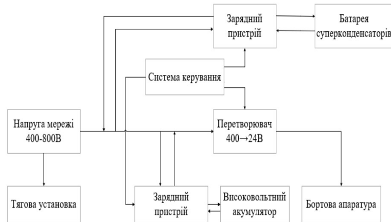
Рисунок 1.3 – Комбінована система електроживлення тролейбуса з високовольтним акумулятором
