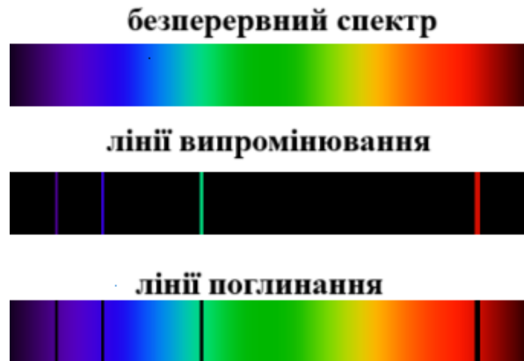
Рисунок 1.3 – Безперервний спектр без ліній; спектр, що з кількох емісійних ліній; безперервний спектр з лініями поглинання
