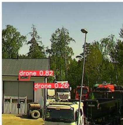
б) Розбите (тайловане) зображення з оригінального. Модель, навчена на фрагментах зображення, виявила хибно-негативний результат (угорі ліворуч), а також помилково виявила дрон (хибно-позитивний результат унизу праворуч).
