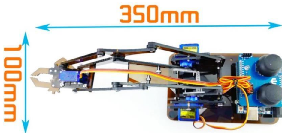
Рисунок 2.5 – Зображення розмірів корпусу макета маніпулятора [15]
