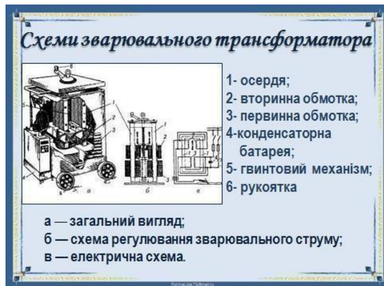
Рисунок 1.7 – Схема зварювального трансформатора
