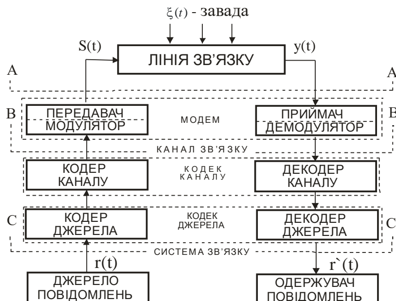
Рис. 1.1. Узагальнена структурна схема СПП
