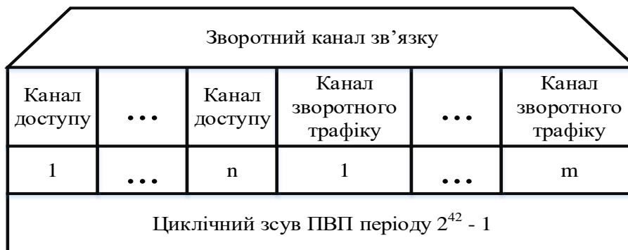
Рисунок 2.17 – Структура зворотного каналу ССС стандарту IS-95
