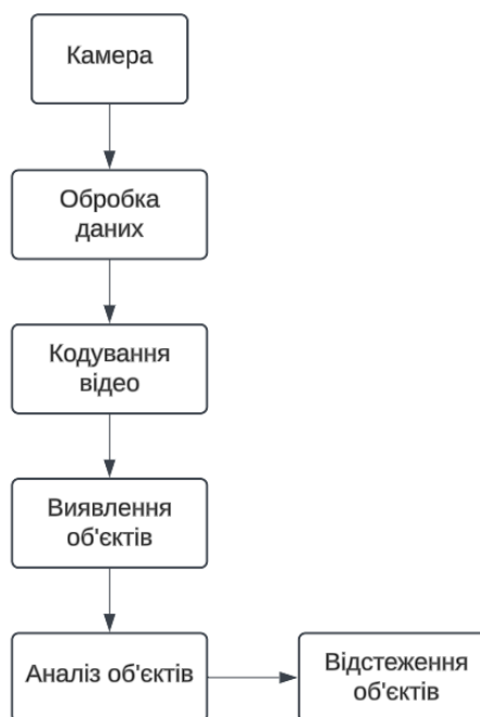
Рисунок 1.1 – Базова схема системи відеоспостереження [1]
