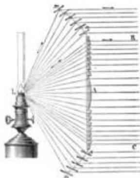
Рисунок 3 – Принцип відображення за допомогою лінзи Френеля
