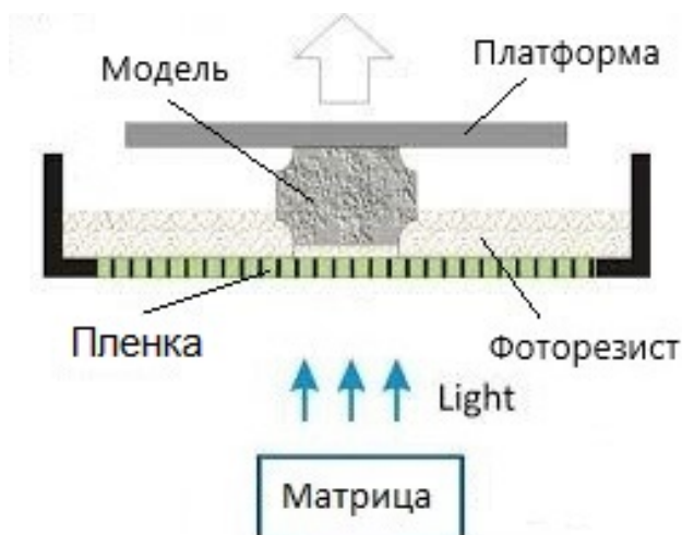
Рисунок 1 – Процес друку моделі за технологією LCD
