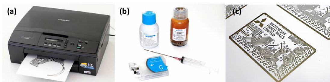
(a) Приклад струменевого принтера з чорнильними картриджами із срібними наночастинками; (b) Срібні нано-чорнило і картриджі для заміни чорнила; (c) Приклад роздруківки з паперових заводів Mitsubishi обмежений
