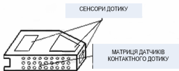
Рисунок 3 – Будова тактильного датчику
