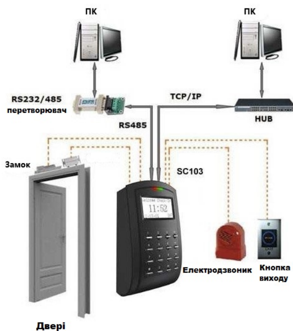
Рисунок 4 – Структурна схема СКУД ViTSC203
