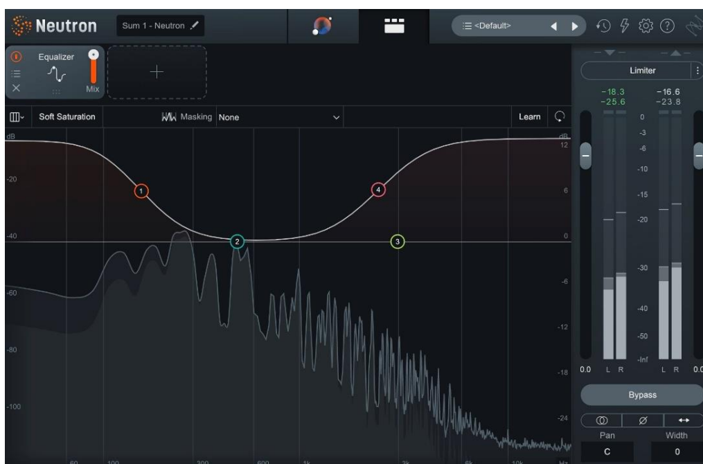
Рисунок 1.3 – Low-shelf та high-shelf фільтри
