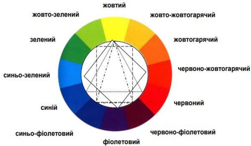
Рисунок 3.6 – Побудова гармонічних сполучень у 12-секторному колірному колі на основі використання геометричних фігур
